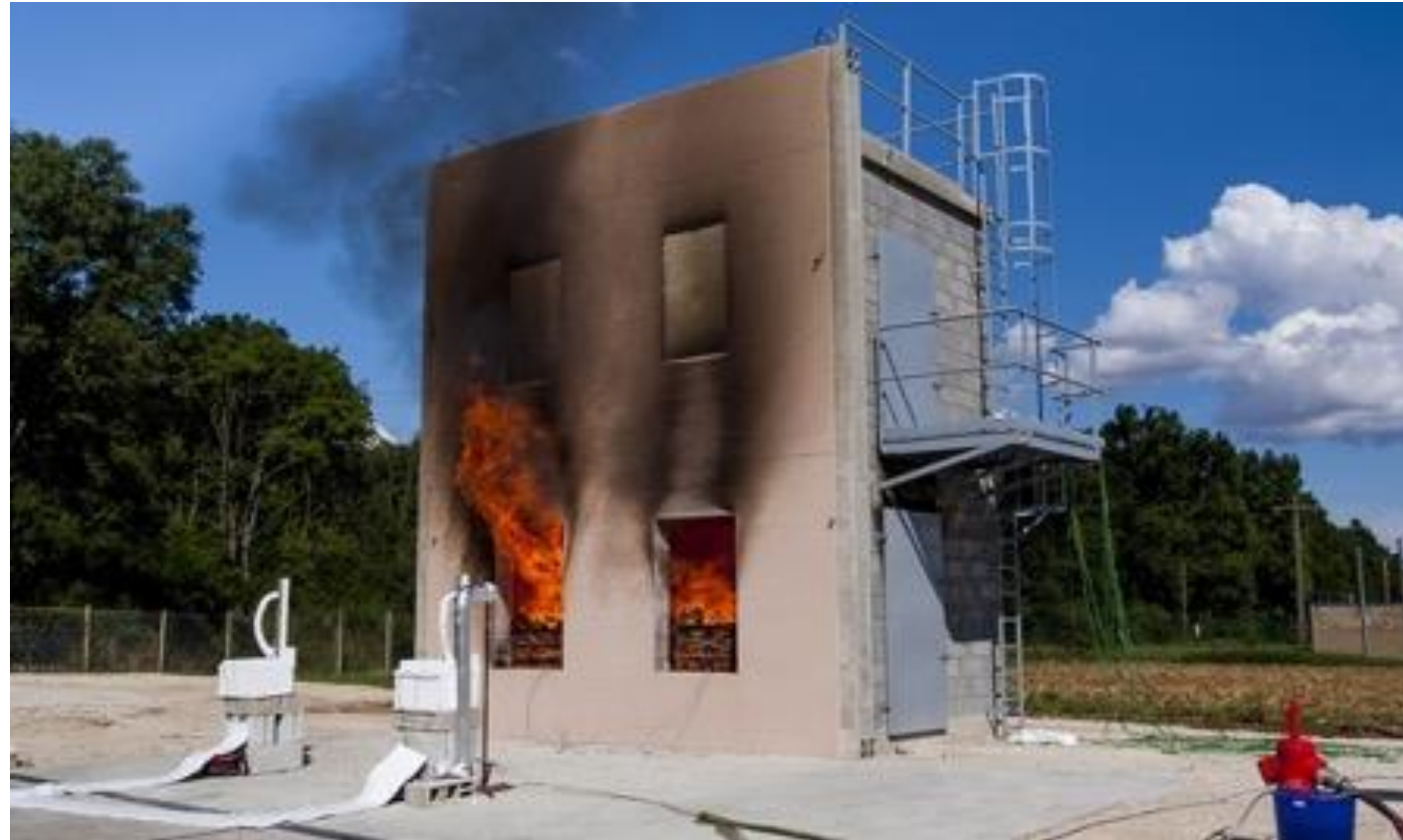
Façade largeur 4,5m - hauteur 6,5 m LEPIR 2 logements collectifs
