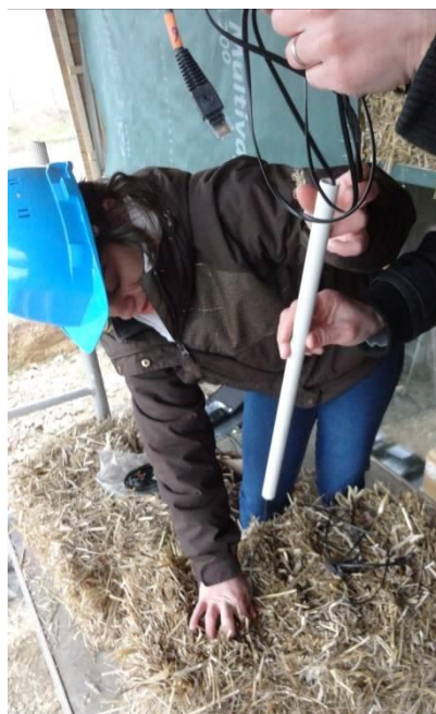
Pose des capteurs humidité et température
